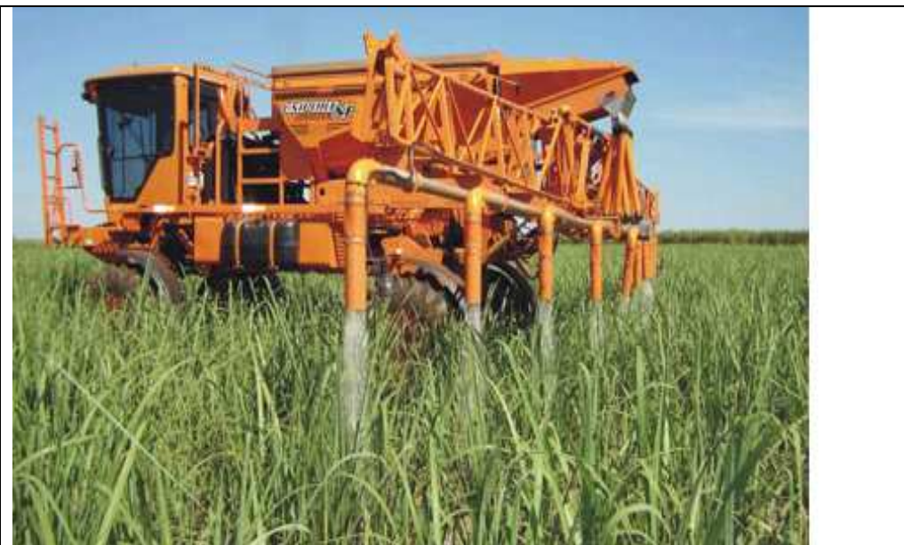
Figura 5. Adubadora NPK Uniport, Jacto. Automotriz, com sistema de distribuição do adubo em taxas variadas para N, P e K seguindo mapas de variabilidade, aplicação do adubo por sistema de fluxo de ar, para 9 linhas de cana. Pode fazer aplicações com taxas variáveis seguindo mapas de fertilidade do solo com orientação do GPS (agricultura de precisão) ou adubações convencionais em taxas fixas. Foto: site Jacto, (2007)
